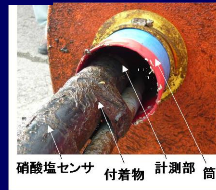
図4 計測部に日光が当たりにくい構造
