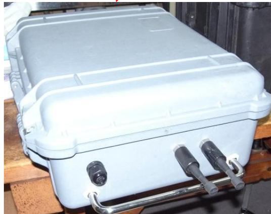
【形状】円筒形は水中に沈めることができます。スーツケース型はアンテナをケースの中に収納でき、筏などに固定して使います。
